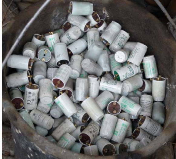
Abbildung 37: Kondensatoren (Starter): Leuchtstoffröhrenlampen
